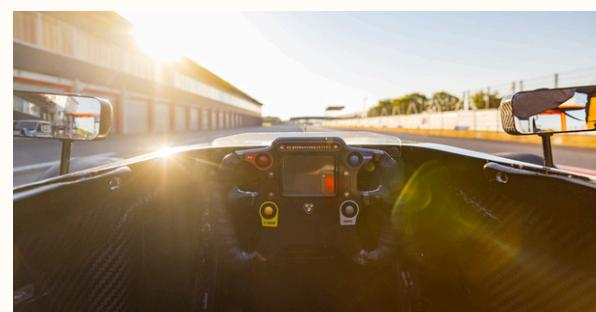
Formule 4 Tatuus : coque carbone, moteur turbo compressé, près de 180 CV pour 500 kg, vitesse de pointe : 250km/h, boîte de vitesse avec palettes au volant 6 rapports
